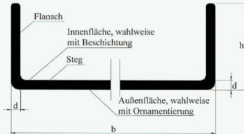
**Profilquerschnitt**    d: Dicke
