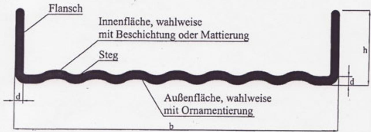
**Profilquerschnitt**    d: Dicke
